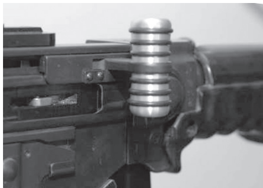
Bild 20: Poignée de charge anatomique pour F ass 57
