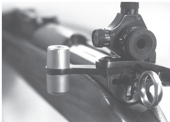
Figure 23: Verrou à gauche pour mousqueton 31
