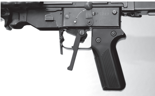
Figura 19: Grilletto ausiliario d'inverno per F ass 57
