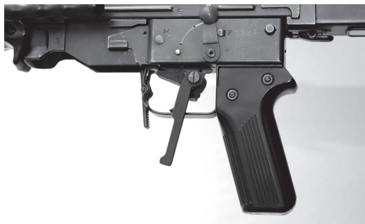
Figura 19: Grilletto ausiliario d'inverno per F ass 57
