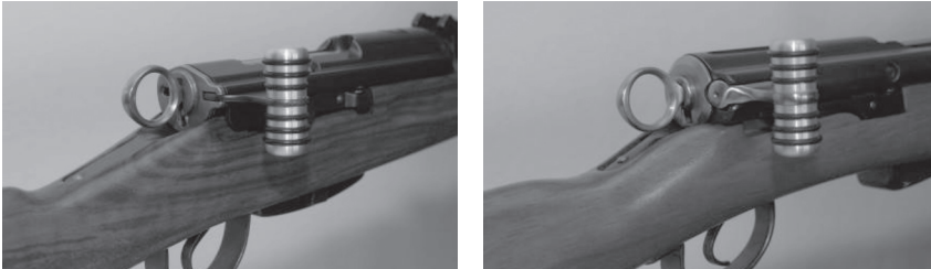
Figure 25: Poignée de verrou anatomique pour mousqueton et fusil
