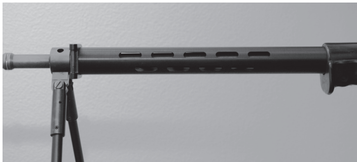
Bild 17: Mantelrohr zu Stgw 57
