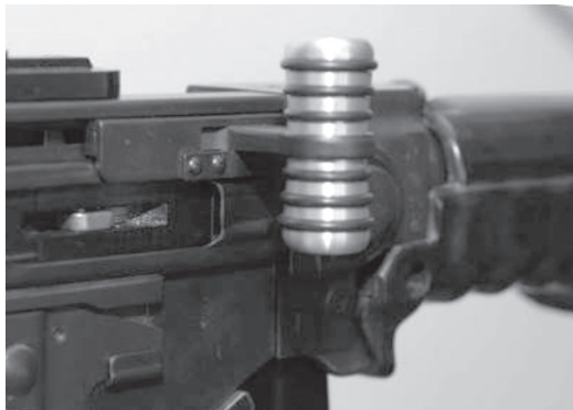
Figura 20: Leva d'armamento anatomica per F ass 57
